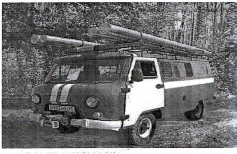
Рисунок 3 - Пожарный автомобиль легкого класса АНР(л)-20-330
