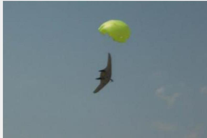
**Посадка БПЛА с помощью парашюта**
