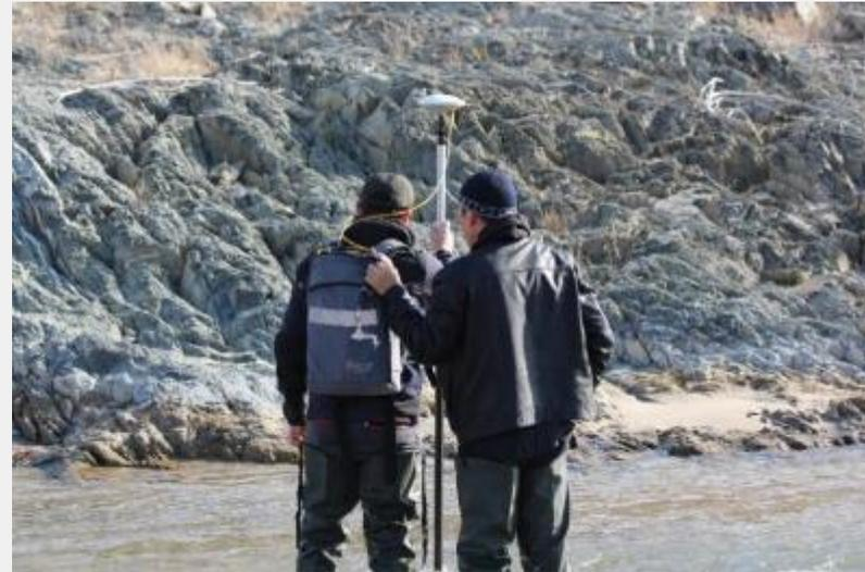
**Топогеодезические работы методом RTK при помощи сервисов RTX (с прибором Trimble R-9s)**
